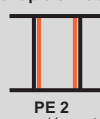
PE 2 Terre supplémentaire - Cuivre SCP Cu 3L+N+50 %PE (conducteurs en cuivre étamé disponibles sur demande)
