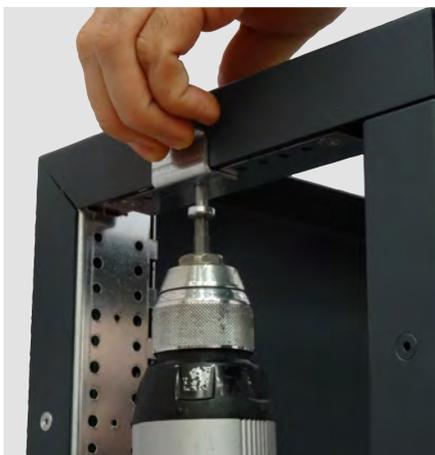
Positionner les écrous-cage dans les trous de l'enveloppe prévus à cet effet puis les tourner d'1/4 de tour de manière à les engager correctement.
