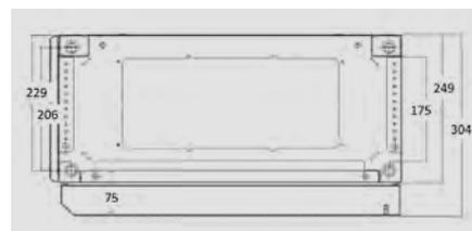
A l'aide de l'illustration ci-dessus, percer le sol à l'aide d'un forêt adapté, insérer les chevilles, positionner les enveloppes et les fixer en se servant des trous des socles (Ø 14 mm).
