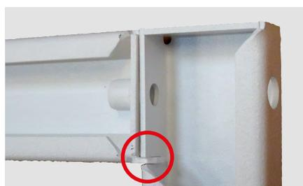
Engager la vis fournie avec le bandeau horizontal et la serrer → Pozidriv n°3, couple de serrage de 8 N.m.
