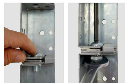
Fixer le (les) support(s) sur l'enveloppe en engageant correctement la languette puis insérer la vis et serrer → clé mâle 8 mm, couple de serrage de 8 N.m.
