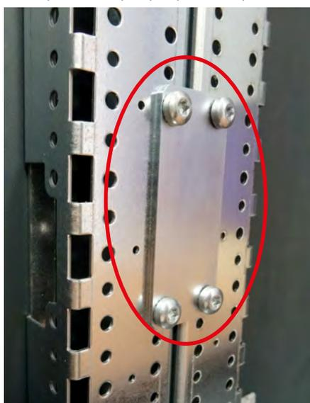
La fixation des vis s'effectue à l'aide d'une clé Torx T30, le couple de serrage est de 8 N.m.
